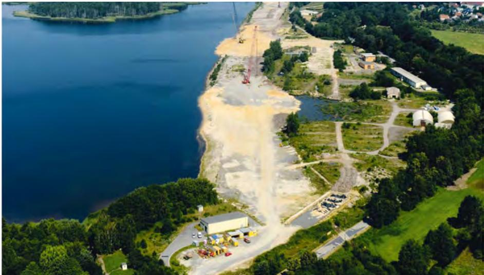
**Abb. 4:** Luftaufnahme des Baubereiches im Juli 2013 während der Ausführung der Tiefenverdichtung
