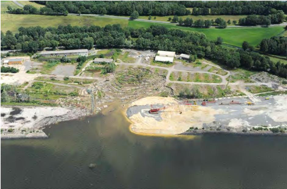
**Abb. 6:** Luftaufnahme des beim Setzungsfließereignis am 8. März 2012 entstandenen Ausflusskörpers
