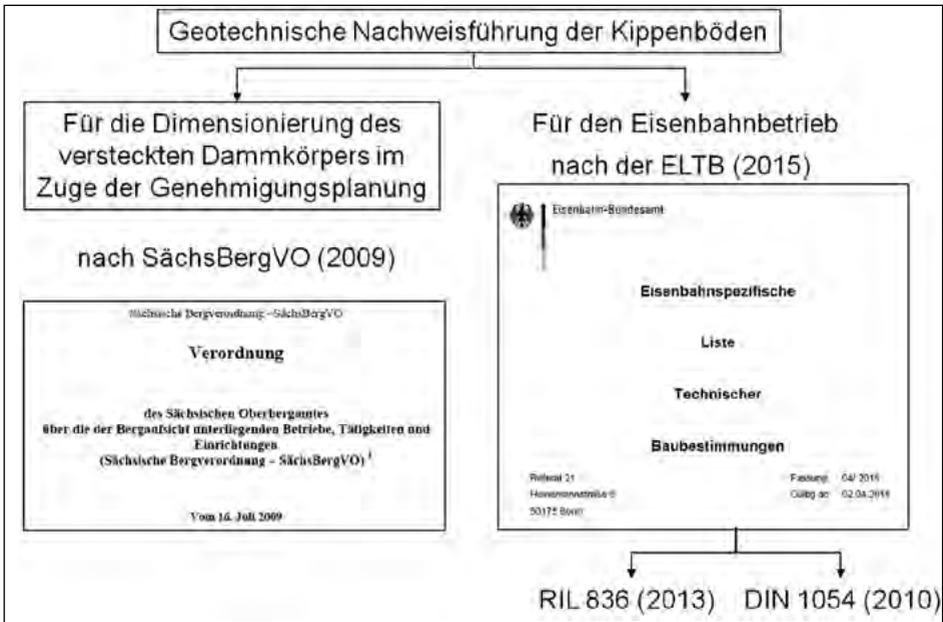
Abb. 8: Geotechnische Nachweise gemäß SächsBergVO (Bau- und Endzustand) und gemäß ELTB (Nutzungszustand)
